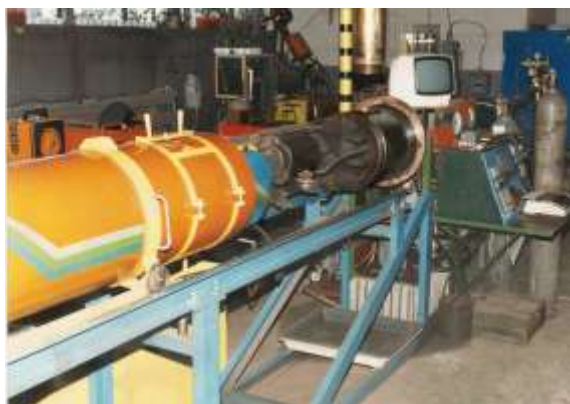
Rys. 21. Unikalna komora symulująca warunki spawania na dużych głębokościach zaprojektowana i wykonana w Zakładzie Spawalnictwa
