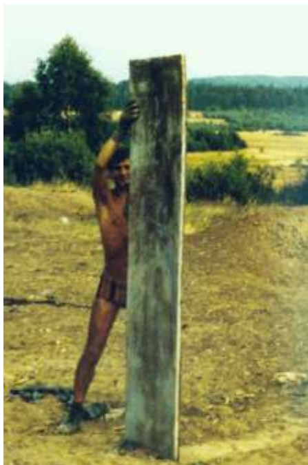
Rys. 20. Pierwsza płyta stal+Al zgrzana wybuchowo
