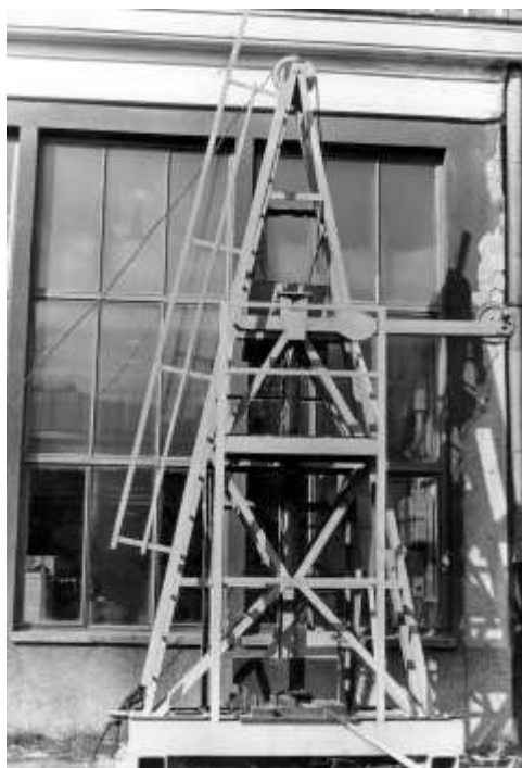
Rys. 19. Młot udarnościowy, o energii uderzenia 1500 kGm, zbudowany w ITMMiS
