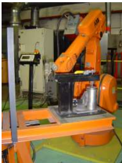
Rys. 22. Zbudowane w Katedrze stanowisko do spawania zrobotyzowanego
